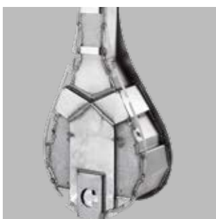
Cámara de combustión (parte posterior): toma de aire exterior y precalentamiento del aire de combustión.
